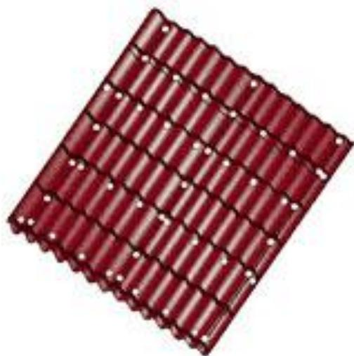
14. Низ листа металлочерепицы прикрепляется саморезами в подошву волны через волну. Следующие ряды саморезов вкручиваются в шахматном порядке через одну волну. Боковой нахлест листов металлочерепицы скрепляется саморезами по гребню каждой волны. Количество саморезов - 6-8 штук на квадратный метр.
