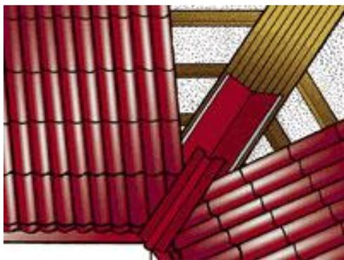
дополнительные доски. Торцевые планки поднимают выше рядовой обрешетки на высоту профиля металлочерепицы.
