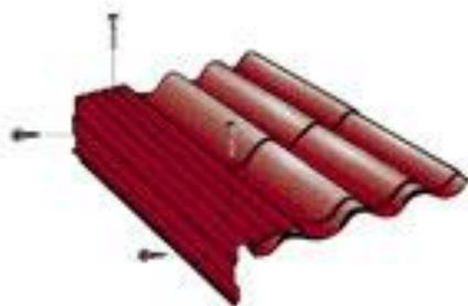
15. На торцы крыши устанавливают планки торцевые. Их закрепляют через 500-600 мм саморезами длиной 28 мм (сбоку) и 80 мм (сверху). Нахлест между планками - 50 мм, при необходимости планки подрезают.
