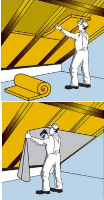
5. После установки гидроизоляции обеспечивается возможность одновременного проведения работ снаружи по устройству кровельного покрытия и теплозвукоизоляционных работ изнутри помещения. Маты или плиты теплоизоляции устанавливаются враспор между стропилами. Между утеплителем и мембранными пленками зазор не нужен.
